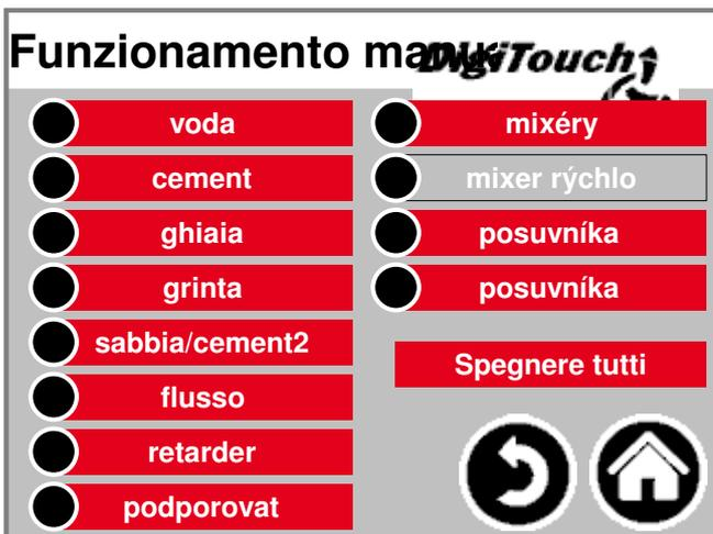
Questa maschera permette il funzionamento manuale dell'individuo Drives. Qui è possibile manualmente commutare le singole funzioni. Alcuni sono come pulsanti, alcuni con Interruttore realizzato. Si prega di fare in funzionamento a secco con la Controllare familiare.
