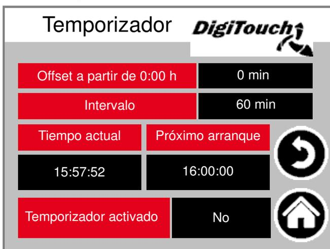
Aquí pueden realizarse las configuraciones del temporizador integrado. Puede activarlo o desactivarlo a continuación. **ATENCIÓN:** si existe un control externo, será este quien asuma la función del temporizador. Entonces, este deberá colocarse como inactivo aquí.
