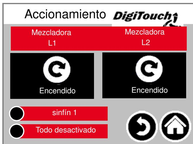
Esta máscara permite el manejo manual del accionamiento individual. Normalmente esto no es necesario. **ATENCIÓN:** en este caso, no hay visualización, la pantalla solo puede utilizarse si está seleccionada en funcionamiento manual.
