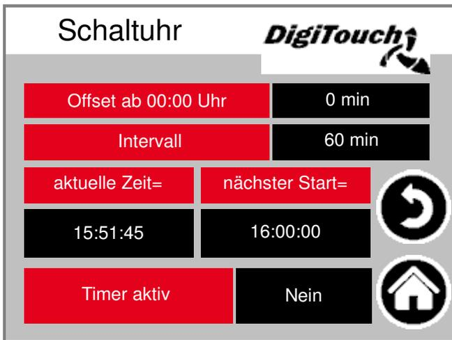
Hier können Sie die Einstellung der integrierten Schaltuhr vornehmen. Unten können Sie diese aktiv oder inaktiv schalten. ACHTUNG: Wenn eine externe Steuerung vorhanden ist, wird diese in der Regel die Funktion der Schaltuhr übernehmen. Dann sollte diese hier auf inaktiv gesetzt werden.
