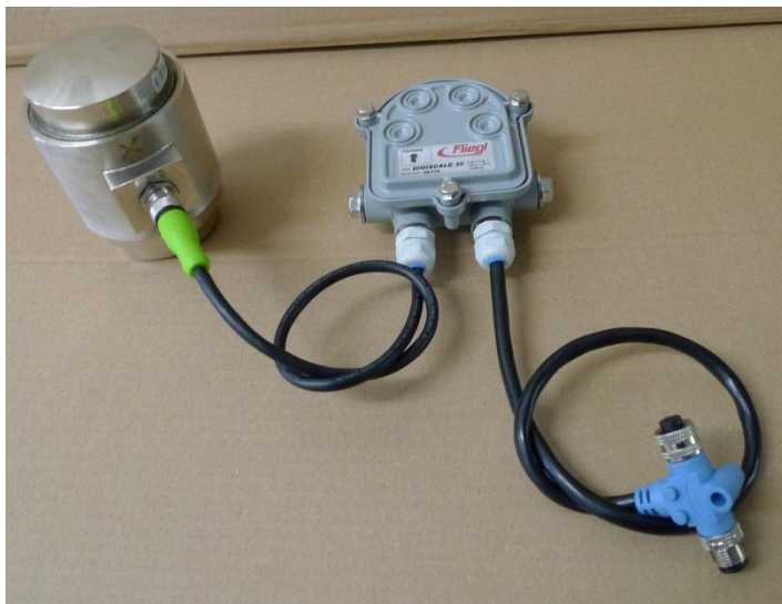
Abbildung 5 Analoge Wägezelle mit externem Verstärker
