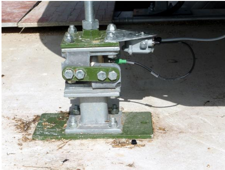
Abbildung 6 Wiegefuss mit eingebauter Wägezelle; Verstärker am Wiegefuss montiert.
