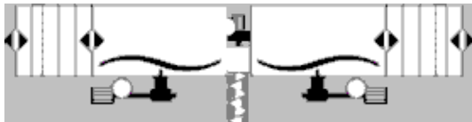
Abbildung 14: Biomat mit Anbaurondomat als Duplexanlage Unteneinbringer (Typ 50)
