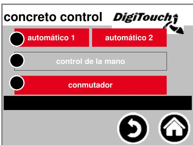
En este menú, puede El funcionamiento automático y manual intercambio, y seleccione. la modo seleccionado es de color depositado. al pulsar el entra en el modo seleccionado en ese uno en el control de este modo. El modo sólo puede ser ser cambiado si el Motor está parado.
