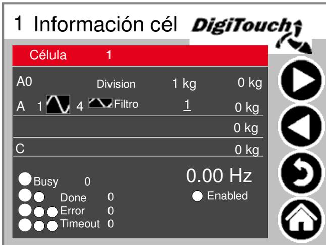
Detalle del menú de ajuste entre otros carga mínima y / o máxima de las células; Filtro A y C
