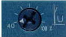
Am Potentiometer U wird die Höhe der Startspannung eingestellt. Der Wert der Startspannung bestimmt die Höhe des Einschalt Drehmoments des Motors. Eine kleinere Startspannung hat ein kleineres Anzugsdrehmoment (sanfteren Anlauf) und kleineren Anlaufstrom zur Folge.
