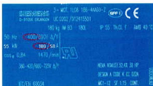
Am Potentiometer  $I_e$  muss der Bemessungsbetriebsstrom des Motors entsprechend der vorliegenden Netzspannung bzw. der Motorverschaltung (Stern/Dreieck) eingestellt werden. Auf diesen eingestellten Wert bezieht sich auch der elektronische Motorüberlastschutz, wenn er aktiviert ist. Zulässige Einstellwerte bezogen auf die gewünschte Motor-Überlastauslöseklasse, siehe Kapitel Motorstromeinstellwerte (Seite 115).
