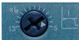
Am Potentiometer  $x_{I_e}$  wird der Strombegrenzungswert als Faktor des eingestellten Motorbemessungsstroms ( $I_e$ ) auf den maximal gewünschten Strom während des Anlaufs eingestellt.
