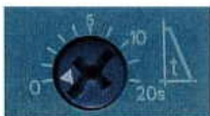
Am Potentiometer t kann eine Auslaufzeit eingestellt werden. Hiermit wird bestimmt wie lange dem Motor nach Wegnahme des Ein-Befehls noch Energie zugeführt werden soll. Innerhalb dieser Auslaufzeit wird das im Motor erzeugte Drehmoment über eine Spannungsrampenfunktion reduziert und die Applikation sanft stillgesetzt.
