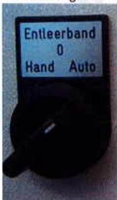
Das Verladeband wird nur laufen, wenn am Schaltschrank der Vorwahlschalter für das Band auf „Automatik“ steht.
