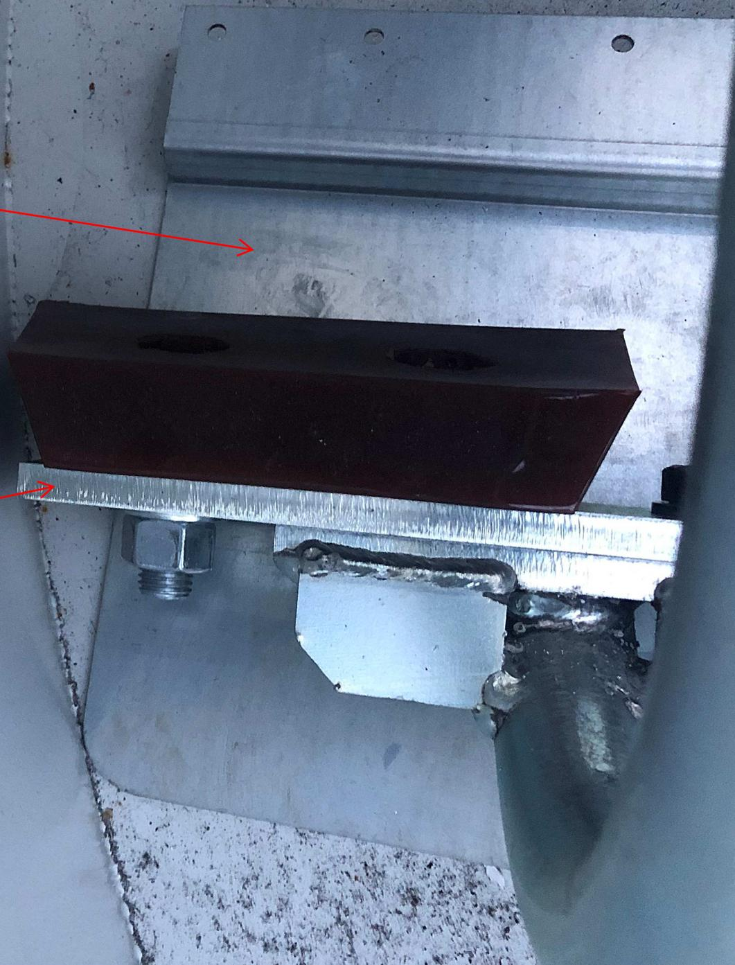
Mischerblatt so montieren, dass ein Winkel von ca. 15° entsteht, und das Mischgut nach Innen geschoben wird.
