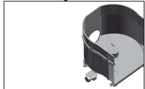
*Costruzione annessa Rondomat Ø 2.400 mm Volumi ca. 14 m<sup>3</sup>, interno/esterno Ø 2.400/2.500 mm; altezza interno/esterno 2.000/2.700 mm*
