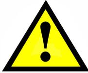
Durante gli interventi di manutenzione e assistenza possono presentarsi energie residue meccaniche e idrauliche sul dispositivo di alimentazione. L'energia residua deve essere ridotta senza pericoli. Le misure corrispondenti si trovano nelle indicazioni del personale di servizio.
