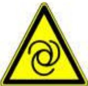
Verletzungsgefahr durch sich bewegende und drehende Teile (durch das Abschiebesystem und die Förderschnecken).
