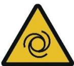
**Verletzungsgefahr durch sich bewegende und drehende Teile (durch das Schubkeilboden und die Förderschnecken).**
