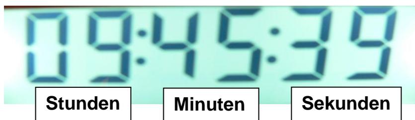
Durch drücken der „**Set-Taste**“ wird die Uhrzeit gespeichert und das Datum auf null zurückgesetzt. Die rechte Null blinkt jetzt. Mit den Tasten „**Tare und Zero**“ kann das entsprechende Datum eingestellt werden. Mit der „**Total-Taste**“ wechseln Sie zu der nächsten gewünschten Ziffer.
